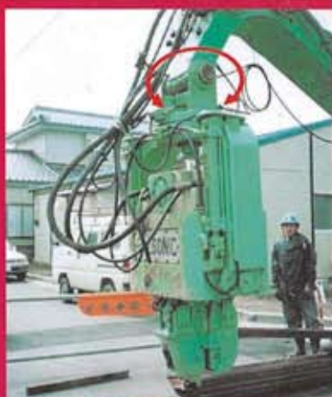
▲遠隔旋回装置で微調整可能。
